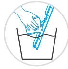
将导风板清洗干净
